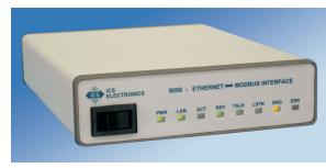
9099 Ethernet-Modbus RTU Interface
